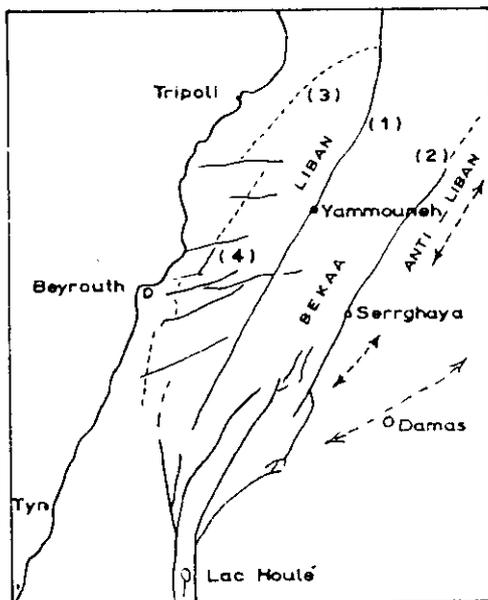
Parallèlement à la côte deux grandes failles poursuivent les failles bordières du lac Houlé et la mer morte au Sud. Ces deux failles, celle de Yammouné (1) sur le flan Est du Mont Liban et celle de Serrhaya (2) sur le flan Ouest de l'Anti-Liban, encadrent la Bekaa, fossé d'effondrement de 8 à 15 Kms. de large et de plus de 100 Kms. de long
